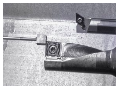
Pomiar narzędzi w tokarce
