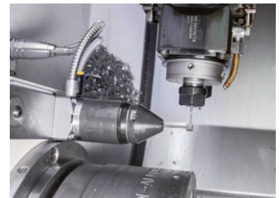
Werkzeugmessung – TC76 mit Schutzhülse
