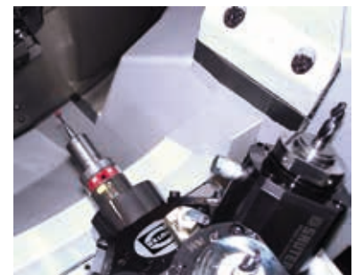
ロータリートランスファマシンでの高速ワーク計測
