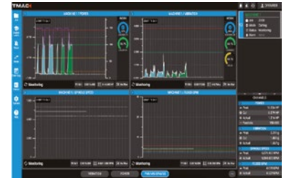
TMAC überwacht mehrere Prozesse und Sensorkanäle gleichzeitig
