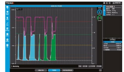
Adaptive Steuerung: Visualisierung von Vorschubeinstellung & tatsächlicher Schnitt
