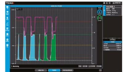
Adaptive Control : Visualisation de l'avance et de la puissance
