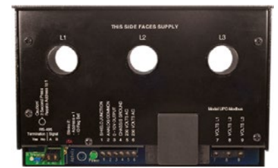
Le capteur de puissance du TMAC contrôle la puissance réelle consommée par la broche
