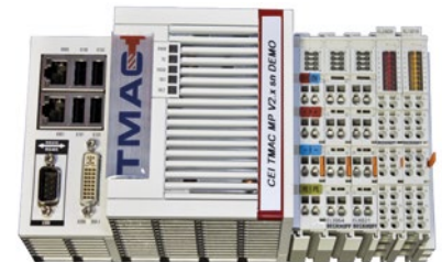
O TMAC IPC processa os dados da potência do transdutor de potência, bem como os comandos CNC e os comunica para o PC front-end.
