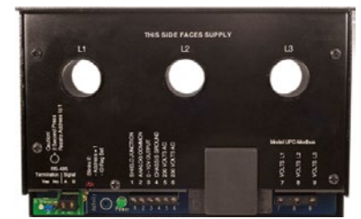
O transdutor de potência TMAC mede a potência do motor do fuso.
