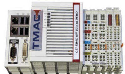
数据收集单元(DCU), 负责从电源传感器收集和处理功率数据, 处理机床CNC控制指令, 及传递数据至PC端。
