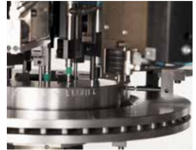
Dynamische Messung mit Erfassung aller Messmerkmale in einer Umdrehung
