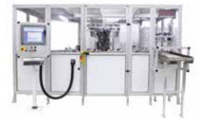
Vollautomatische In-Line Messanlage mit Beschriftungssystem und Statistikrechner
