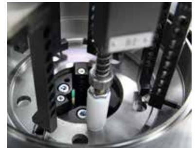
Präzise Innenmessung von Bremstrommeln
