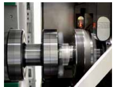
Integriertes Lasermesssystem LC50-DIGILOG zur Rundlaufmessung
