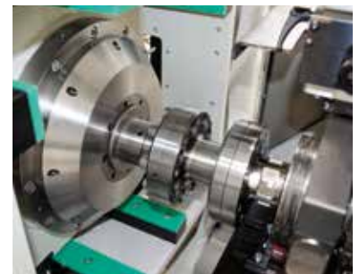
Verbindungswelle zwischen Belastungsmotor und Prüfspindel
