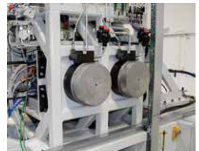
Rahmen mit hydraulischen Membranzylindern
