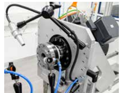
Antriebseinheit rechts mit Axialverstellung
