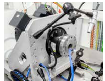
Antriebseinheit links mit Winkelverstellung
