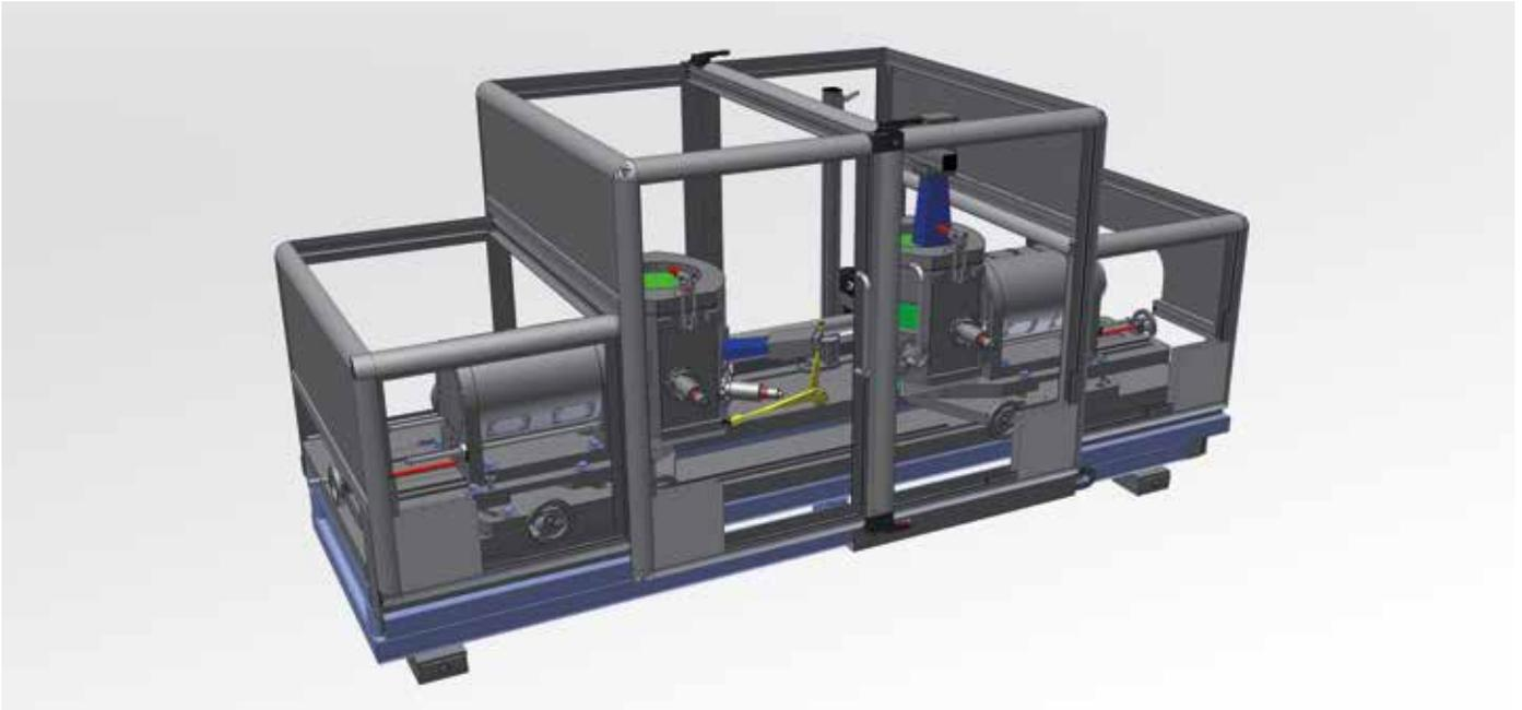
Dieser Prüfstand dient der Bestimmung der Rotationsfähigkeit der Faltenbälge, unter verschiedenen Drehzahlen, Beugewinkel und Temperaturen zwischen Raumtemperatur und +200 °C.
