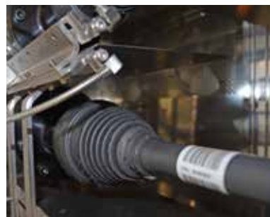
油脂泄漏监控
