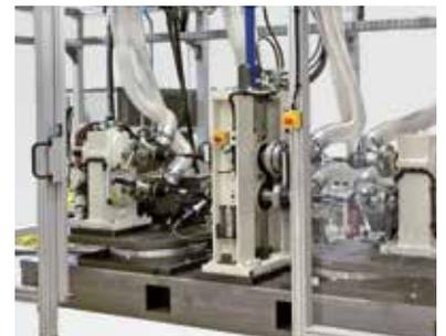
Beugeinheiten und Pulsator für die Simulation einer Fahrtstrecke
