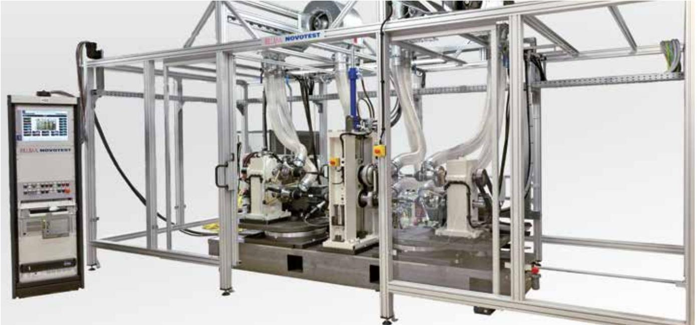
Mit dem Lebensdauerprüfstand werden die Parameter – Drehzahl, Drehmoment, Federweg, Lenkwinkel, Gelenktemperatur – gemessen und geregelt. Vier Gelenkwellen werden gleichzeitig, in einem geschlossenen Kreislauf, mit Multi-Block-Programmen getestet. Alle sicherheitstechnischen Abfragen (Gelenktemperatur, Schmierölkreislauf, Vergleich von Soll- und Istwerten, Not-Aus-Einrichtungen, Fettaustritt usw.) sind während der Prüfung im Einsatz und stoppen den Prüfstand automatisch bei Fehlermeldungen.
